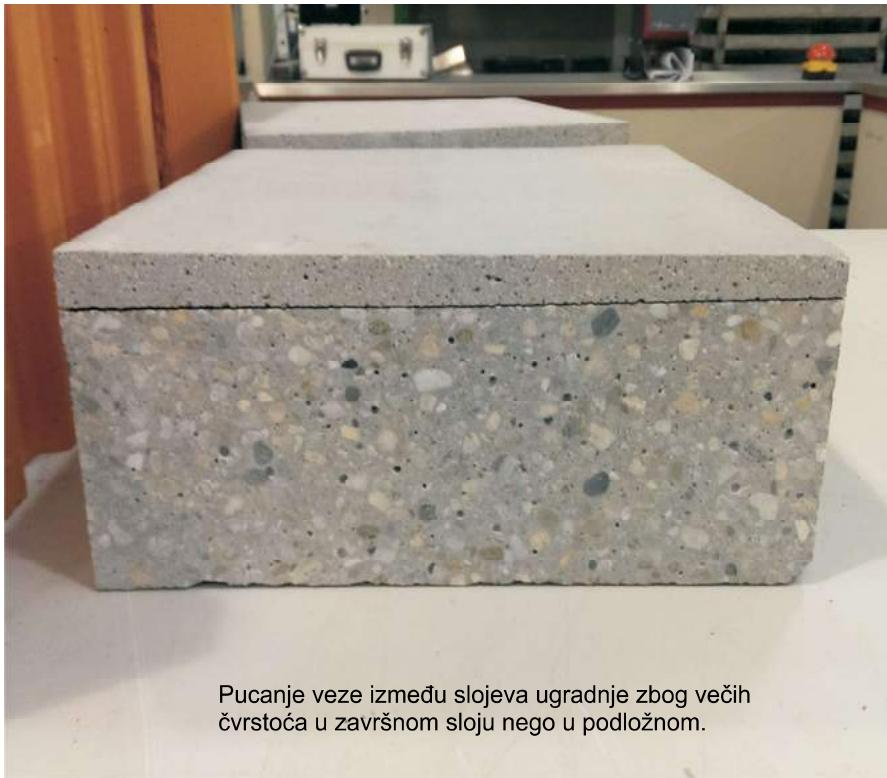
Pucanje veze između slojeva ugradnje zbog većih čvrstoća u završnom sloju nego u podložnom.
